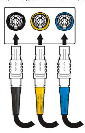
Разъемы на концах кабеля снабжены фиксирующим выступом, который при подключении устанавливает его в правильное положение.
