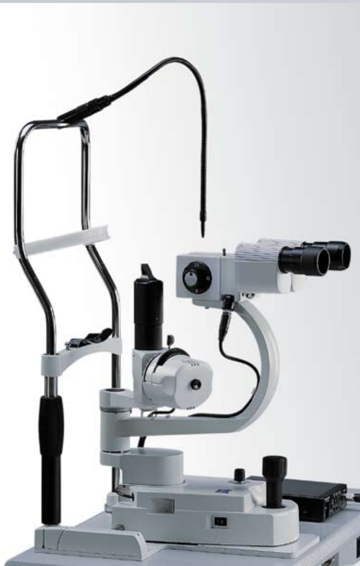
Апланационный тонометр AT 020
