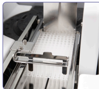
Загрузчик кювет для 36 мультикювет по 10 реакционных ячеек в каждой (всего 360 ячеек).
