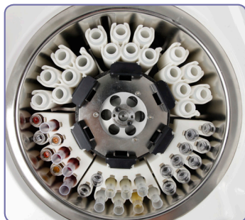
Комбинированный диск для образцов и реагентов максимально на 6 штативов.
